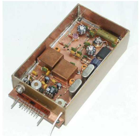
Рисунок 7 Внешний вид блока ПЧ
